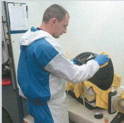
**FEINER LACK:** Die Gehäuse werden in mehreren Schichten lackiert und anschließend von Hand auf Hochglanz poliert. Die weiße Variante bekommt ein mattes Finish.
