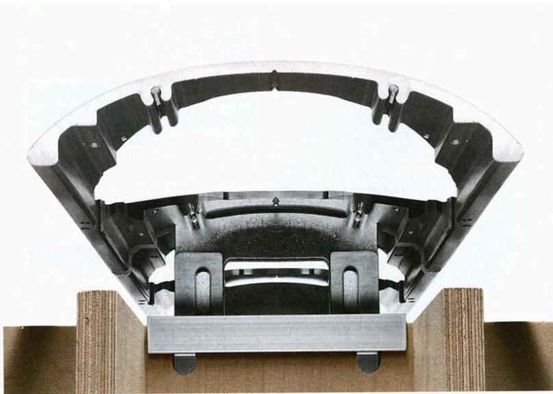
Kein direkter Kontakt: B&W hat aufwendig die „Matrix“ im Inneren der 803 neu verschachtelt. Was auffällt: weniger Verstrebungen, dafür aber wuchtige Platten aus Schichtholz. Die Chassis selbst liegen nicht auf der Außenhaut auf: Über einen Alu-Rahmen werden sie mit Stahlzangen an eine Alu-Schallwand im Inneren der Matrix angeklemt.
