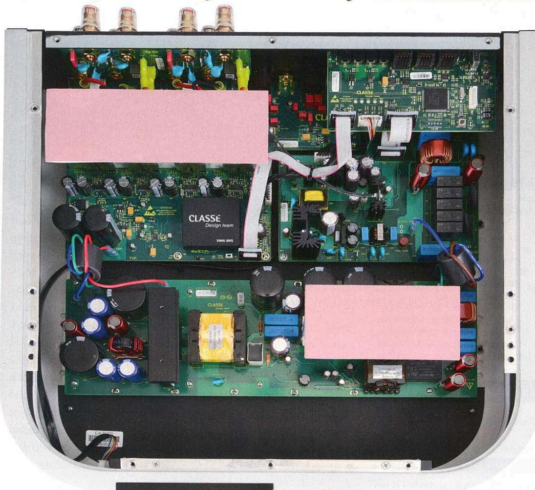
als Tiefpass ausgelegt wurde, sondern vielmehr als Bandpass, also auch oberhalb der Filterfrequenz (hier die 384 kHz der Schaltfrequenz) wieder Durchlass bietet. Natürlich haben die Designer dem kräftigen Verstärker auch umfangreiche Schutzschaltungen mitgegeben: etwa gegen Überlast, Gleichspannung am Eingang und extreme Betriebstemperaturen.
