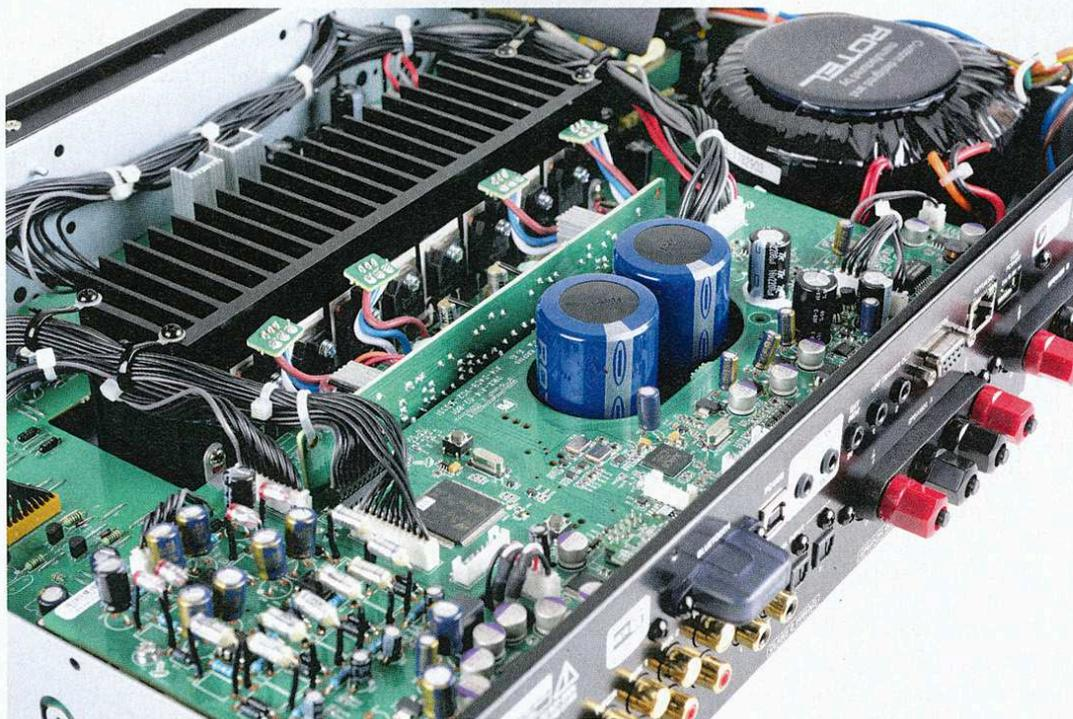
Doppelte Lautsprecher-Ausgänge und ein Vorverstärker-Ausgang runden das üppige Anschlussmenü des A14 ab. Seine serienmäßig eingebaute Phonostufe (unten links im Bild) ist für MM-Tonabnehmer geeignet, neben den Phonobuchsen bietet der Rotel noch vier analoge Hochpegeleingänge.
