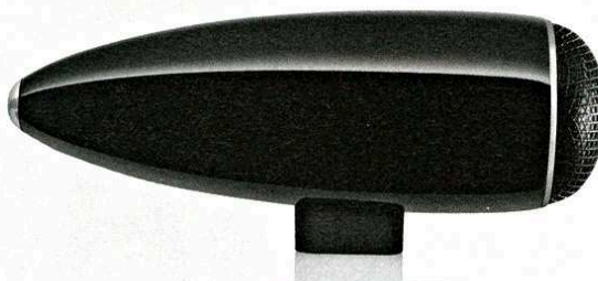
MASSIVER TORPEDO: Das dicke Aluminiumgehäuse des Tweeters unterdrückt lästige Schwingungen effektiv und nimmt die Abwärme des Hochtöners gut auf.
