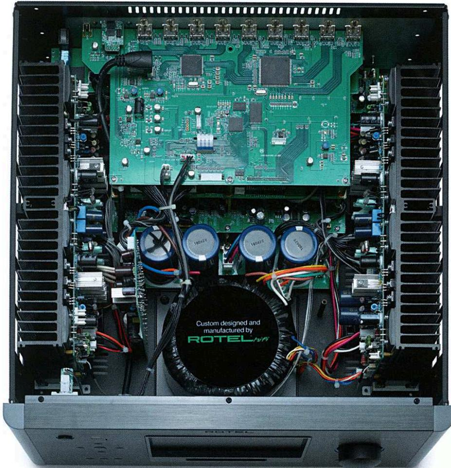
**MUSKELBEPACKT:** Das Innenleben des RAP-1580 offenbart den grossen Aufwand, den die Ingenieure bei der Konzeption von Netzteil, Kühlkörper und Endstufen getrieben haben. Der 7-Kanal-Verstärker arbeitet im klassischen A/B-Betrieb.
