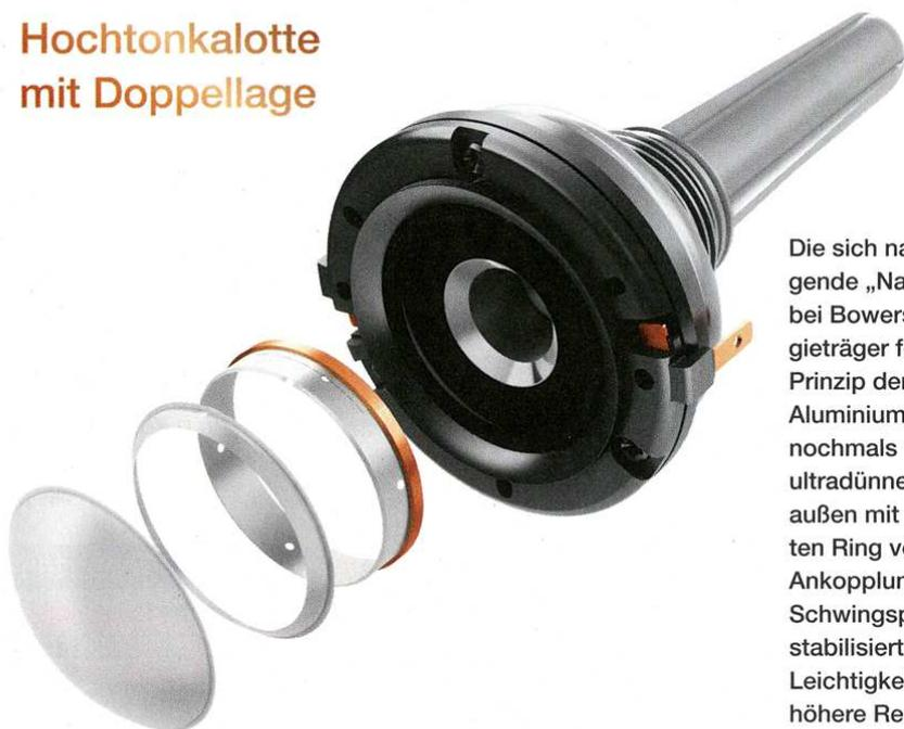
Die sich nach hinten verjüngende „Nautilus“-Röhre ist bei Bowers als Technologieträger fest gesetzt. Das Prinzip der doppellagigen Aluminiummembran wurde nochmals verbessert, eine ultradünne Kalotte wird außen mit einem verstärkten Ring versehen, der die Ankopplung an den Schwingspulenträger stabilisiert. Das sorgt für Leichtigkeit und eine höhere Resonanzfrequenz.
