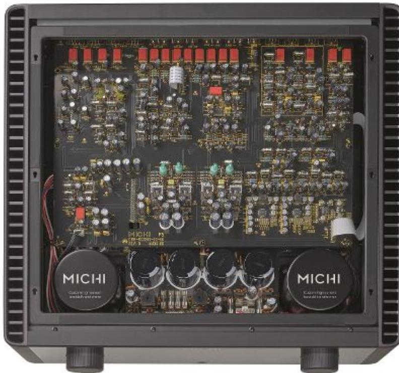
**Mustergültiger Innenaufbau des P5. Das opulente Netzteil würde selbst einem Vollverstärker gut anstehen.**
