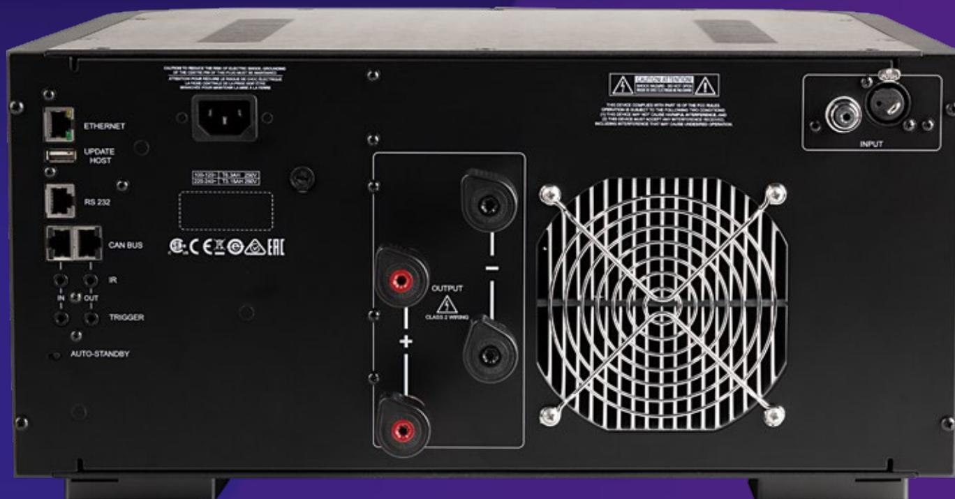
Hinter dem ausladenden Ventilationsgitter sitzt ein stiller Lüfter, welcher die Elektronik der Endstufe mit kühlendem Luftzug versorgt. Somit ist das Gerät nicht abhängig von passiver Kühlung, sodass andere Geräte auf dem Gehäuse geparkt werden können. Freilich lassen sich beide Endstufen via Trigger einschalten und automatisch in den Standby versetzen.
